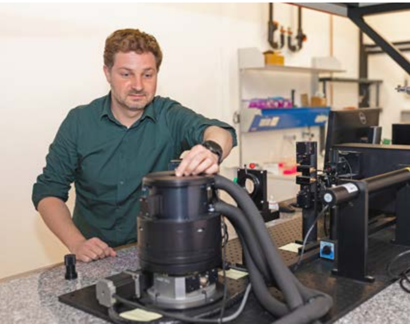
◀ Prof. Karg an einem Laseraufbau zur Messung von Streulicht.
