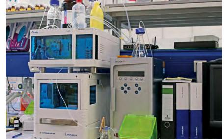
Die High-Performance Liquid Chromatography (HPLC): Mit ihr können chemische Komponenten in einer Flüssigkeit identifiziert und quantifiziert werden. Prof. Kalenscher und sein Team verwenden die HPLC für die sogenannte Mikrodialyse, bei der sehr kleine Mengen Hirnflüssigkeit aus einer bestimmten Hirnregion entnommen werden und auf Neurotransmitter wie z. B. Dopamin oder Serotonin analysiert werden können.
