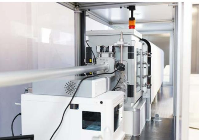
Gerät an CSS zur Kleinwinkel-Röntgenstreuung (SAXS). Hiermit können Proteinstrukturen in Lösung aufgeklärt werden.
