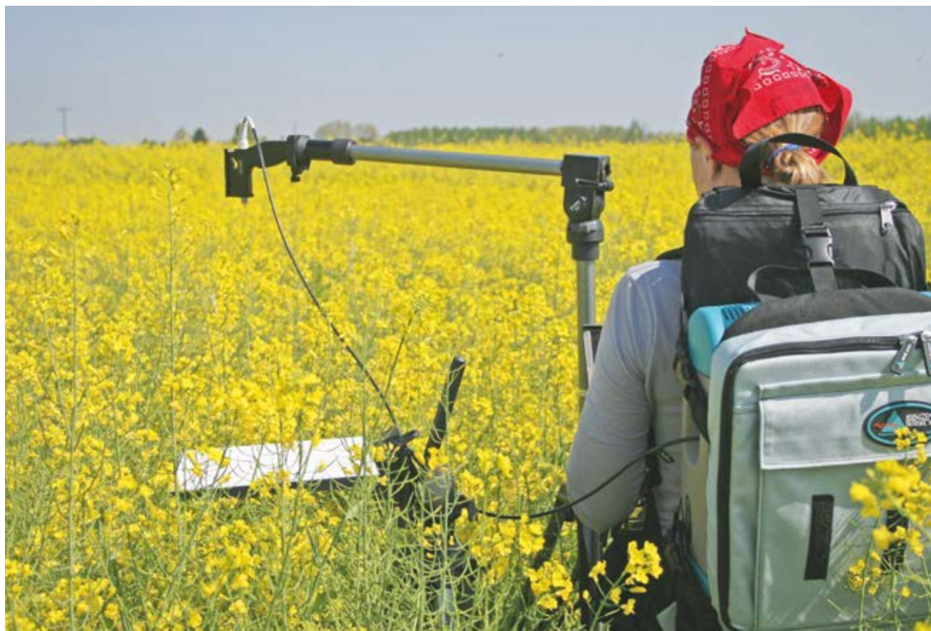
Reflektionsmessungen im Feld: Ertrags- und Funktionscheck von Raps.
